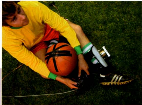
Fußball, interaktiv: Der „Leg Shocker“ (Bild rechts) erweitert die Interaktionsmöglichkeiten für die Spielekonsole Playstation 2 von Sony. Das Interface bezieht die Körper der Spieler direkt in das Geschehen mit ein. So beeinflussen etwa reale Schmerzen (bei Fouls) das Spiel – oder das Kicken eines Balles, der an eine solide Springfeder montiert ist. Abbildungen: Volker Morawe und Roman Kirschner, KHM.
